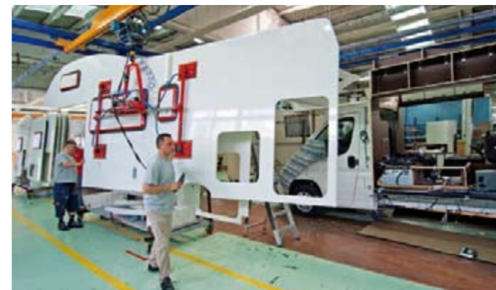
Ja kun sisustus on enää viimeistelyä sekä tekstiilejä vaille, asennetaan sivuseinät, joihin on tehty luukkujen sekä ikkunoiden asennus jo ainakin puolivalmiiksi. Myös sisäpuoli on tapetoitu valmiiksi.
