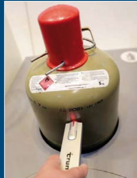
Truma esitteli uuden paristokäyttöisen LevelCheck laitteen, joka on teräksisten ja alumiinisten kaasupullojen täyttöasteen näyttävä laite. Ultraäänen avulla laite havaitsee, onko pullossa kaasua vai ei. Vihreä valo osoittaa, että kyseisessä kohdassa on nestettä. Punainen valo kertoo tyhjästä pullost. Laitteen kerrotaan toimivan myös talviolosuhteissa.
