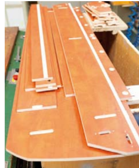
Vas. Tietokoneen ohjauksella leikattuihin levyihin jyrjitään upotukset tukevia liimaliitoksia varten.
