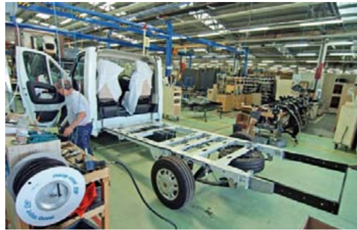
Alustan muutostyöt kuten taka-akseliston muokkaus tai runkopalkkien jatko tehdään jo heti, kun auto tulee sisälle tehtaaseen.
