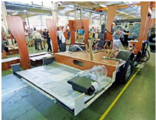
Pitkä takaylitys on osittaisten lattiaa tukevien jatkopalkkien varassa, mutta vetokoukku näihin ei voi asentaa.
