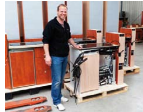
Vas. Kaikki kalusteet kootaan valmiiksi kokonaisuuksiksi johtoineen ja letkuineen. Yksi henkilö tekee kalusteen alusta loppuun.
