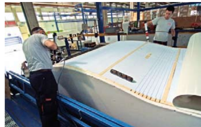
Katon pinnan asennus tehdään nosturilta käsin. Puiset kulmalistat kertovat, että tässä valmistettava auto on eteläisten markkinoiden versio.
