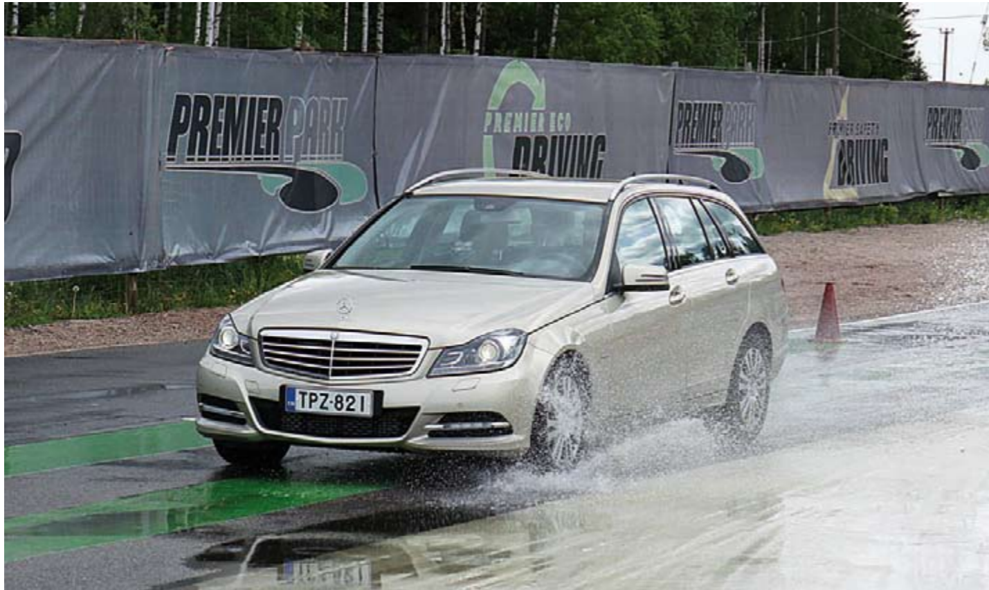
Kitkarengas on kohtuullinen jarrutettaessa, mutta sivuttaisia voimia talvikäyttöön suunniteltu rengas kestää huonosti.
