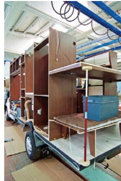
Vas. Kaikki valmistajat painottavat puutyön laadun tärkeyttä kokonaisuuden kannalta. Kaapistojen pitää istua millilleen. Ovien pitää pysyä kiinni matkan rynkytyksissäkin. Ja kun seinät kootaan kaapistojen ympärille, tulee mittojen olla oikeat seiniinkin nähden.
