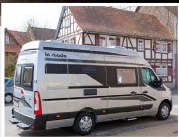
Myös liukuovessa on kaksinkertainen ikkuna verhoihin. Porras menee sisään automaattisesti käynnistettäessä.
