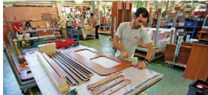
Samaan aikaan, kun alustaa valmistellaan kalusteiden asennukselle, on puulinjalla jo esikoottu kaapistoja joko omalla tehtaalla tai alihankkijalla valmistetuista levyistä. Tässä vaiheessa matkailuautotehdas vaikuttaa enemmän huonekalutehtaalta, mutta toisaalta kalustevalmistus onkin suuri ja tärkeä osa prosessista.
